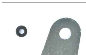
Abb. 2: Ist das Hinterrad mit einer Schraubachse ausgestattet, entfernen Sie den Adapterring aus der Achsaufnahme des Adapters.
