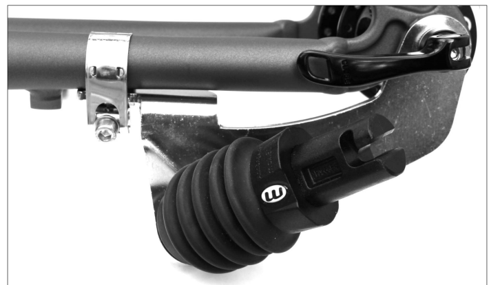
Abb. 4: Adapter mit Weberkupplung, montiert an einem Scorpion fs 20 mit Schnellspannachse (im Bild zur besseren Übersicht ohne Hinterrad)
