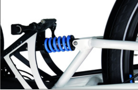
Federelement mit Stahlfeder. Durch das Drehen des Einstellringes am vorderen Ende der Feder stellen Sie die Federvorspannung ein.
