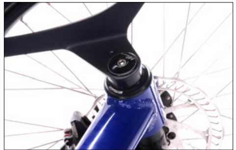
Steuerkopflager mit Abdeckkappe und montiertem Schutzblech
