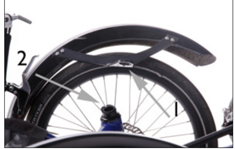
Madenschraube (1) und Klemmschlitz (2) bei der Schutzblechmontage
