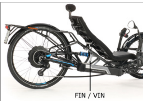
Position der Fahrzeugidentifizierungsnummer (FIN, engl.:VIN)
