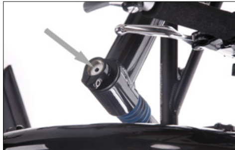
Einstellschraube für die Federvorspannung im Inneren des Federbeins
