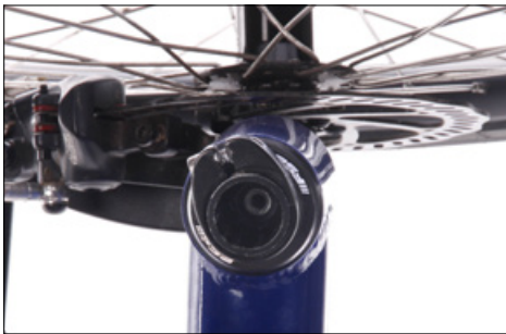
Steuerkopflager mit Kralle im Inneren des Steuerrohrs
