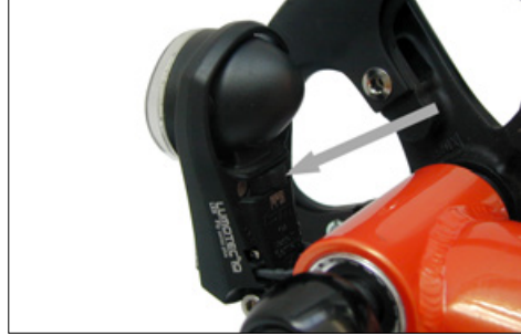
Die Beleuchtung wird mit dem Schalter am Scheinwerfer ein- und ausgeschaltet
