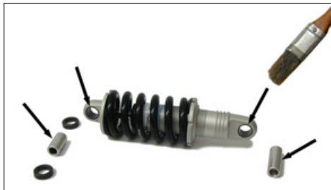
Die Lagerbuchsen des Federesementes müssen mit Fett geschmiert werden.
