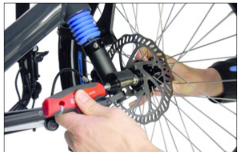
Vorderradausbau: Lösen der Schraube im Endstück
