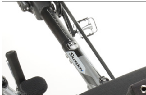
Skala am Tretlagerausleger und Markierung auf dem Rahmen
