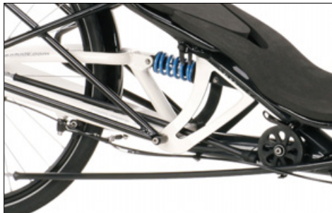
Kettenleitrolle, Kettenfangwinkel und Kettenschutzrohr am Scorpion fs26
