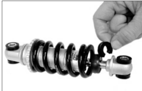
Durch das Aufstecken von Distanzclips auf die Kolbenstange des Federelementes wird der Federweg begrenzt.
