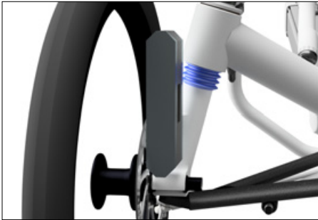
Richten Sie den Winkelmesser parallel zur Bremsscheibe aus.
