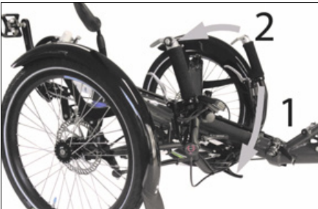
Der Lenker lässt sich bei Scorpion-Modellen in der Breite (1) und in der Neigung (2) verstellen
