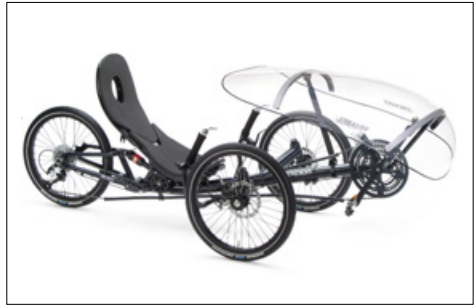
Wetterschutzverkleidung STREAMER am Scorpion
