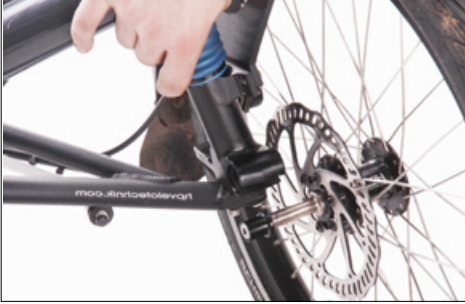
Vorderradausbau: Laufrad aus dem Radträger lösen
