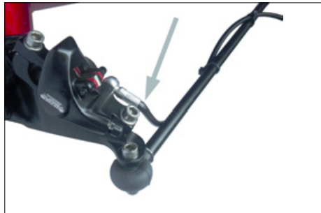
FALSCH: Der Bogen der Hydraulikleitung liegt unter der Spurstange: Gefahr des Abknickens der Leitung (Pfeil).
