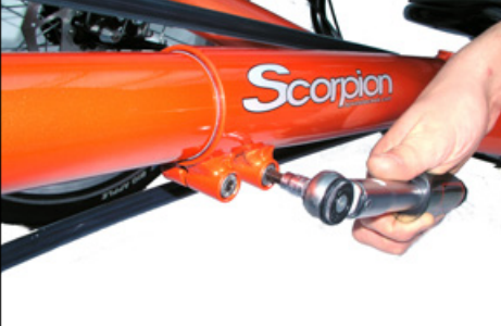
Lösen der Klemmschrauben zum Verstellen des Tretlagerauslegers.
