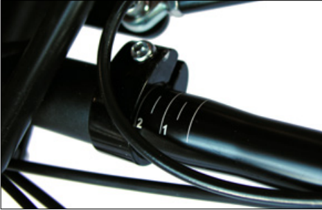
Die Verstellung von Lenkerneigung und -breite erfolgt über die Klemmschellen am Lenkervorbau unter dem Rahmen
