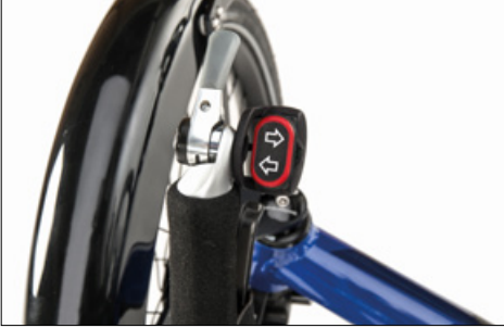
Blinkerschalter am Lenker
