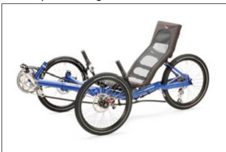
Der Sitz an Gekko-Modellen verbleibt beim Falten am Rad
