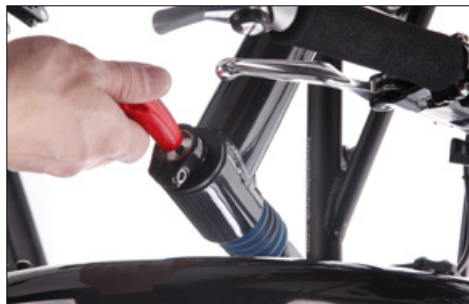
Um die Einstellschraube für die Federvorspannung drehen zu können, muss die Klemmschelle gelöst werden
