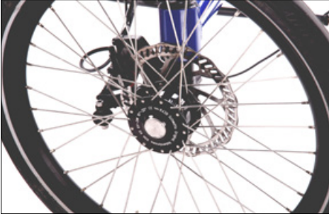
SON Nabendynamo im Dreiradvorderrad
