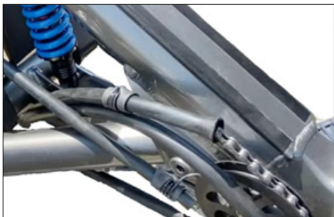
La chaîne est glissée entre les tubes du bras oscillant.
