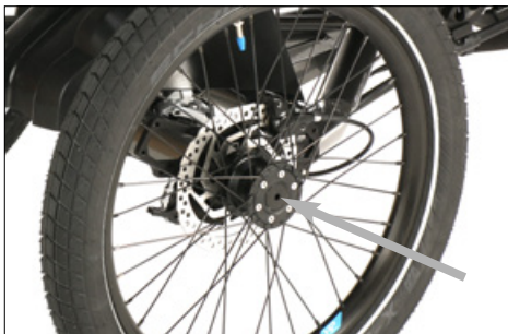
Vis de fixation centrale du moyeu de la roue arrière
