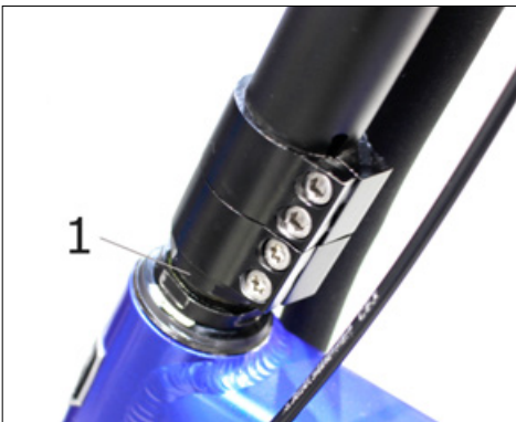
1 - Dispositif de réglage pour ajuster le jeu du palier de commande
