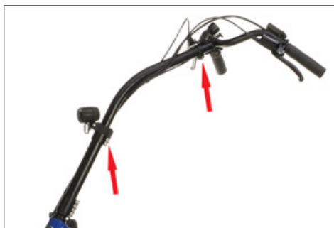
Profondeurs d'insertion minimales des éléments de potence :La fente de serrage (en haut) et le perçage (en bas) doivent être complètement remplis par l'élément de potence situé à l'intérieur.
