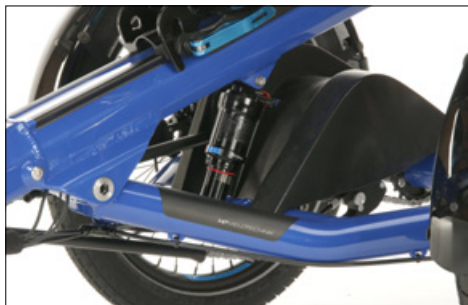
Élément de suspension pneumatique RockShox Monarch (en option)
