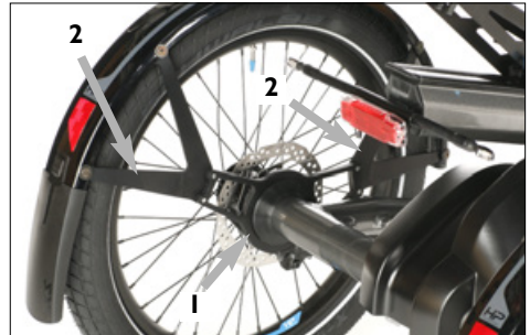
1 - Tôle de montage de frein 2 - Support de garde-boue
