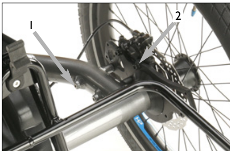
1 - Fixation de la plaquette de frein 2 - Fixation de l'étrier de frein
