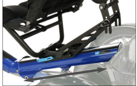
L'adaptateur de siège peut être déplacé sur la partie arrière du cadre principal afin d'adapter la position du siège à la longueur des jambes.
