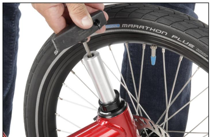
Fixieren des eingesetzten Steuerrohradapters
